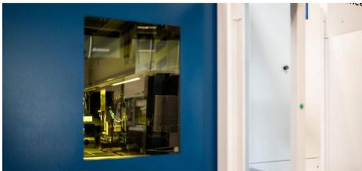
Lasersichere Scheiben lassen sich meistens an ihrer grünen Färbung erkennen. Eine lasersichere Scheibe trägt neben einer CE-Kennzeichnung weitere Angaben, zum Beispiel zur Schutzstufe.
