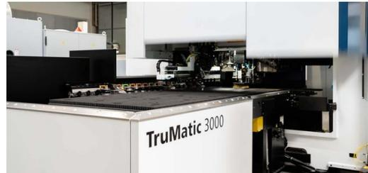
Bei der [TruMatic](#) schirmen Hauben den Bearbeitungskopf ab, Schutzwände am Arbeitstisch fahren bei Bedarf nach oben.
