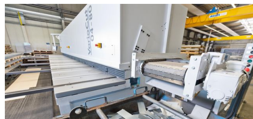
<p>Eine an der EHT VarioCut angeschlossene Schneideanlage, zerteilt Schrott in kleine Stücke.</p> <p>Bild: Dirk Egelkamp</p>
