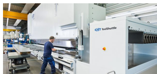
<p>Das leichte und ergonomische Arbeiten ermöglicht der an der VarioPress angeschlossene Werkzeugspeicher ToolShuttle.<br /> Im ToolShuttle lagern die zwei Biegestempel, die 99 Prozent der Kantvorgänge
