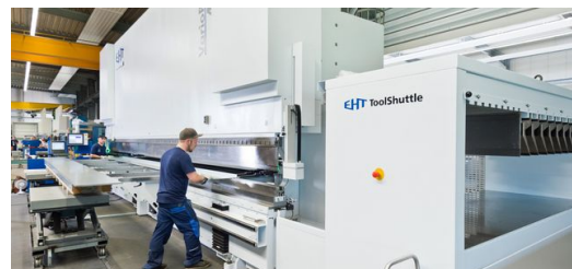
Das leichte und ergonomische Arbeiten ermöglicht der an der VarioPress angeschlossene Werkzeugspeicher ToolShuttle.
