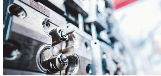
Um dieses Spritzgusswerkzeug für den Bürstenträger geht es. Nach außen ragt der per LMF und LMD hergestellte Stahlstift. (Bild: Philipp Reinhard)
