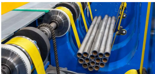
Nach dem Zuschnitt der Rohre auf der TruLaser Tube 7000 werden die Rohre zum Anlagenverbund transportiert, wo der Roboter sie in eine Bündelmulde einlegt und anschließend auf einem Tisch vereinzelt.
