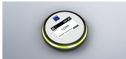
<p>Marker: Nutzer können die Auftragsnummer und weitere Informationen digital auf das E-Ink-Display des Markers übertragen. Danach platzieren sie ihn einfach auf oder neben den Teilen des Auftrags.</p>
