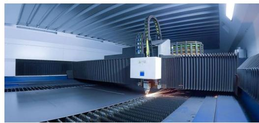
Laserová hlava vytváří díly z nekonečného pásu plechu pro vnitřní části traktoru Fendt.
