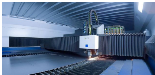
<p class="MAGAFIetext">Laserová hlava vy:ezává díly z nekone:ného pásu plechu pro vn:jší ástí traktor: Fendt.</p>
