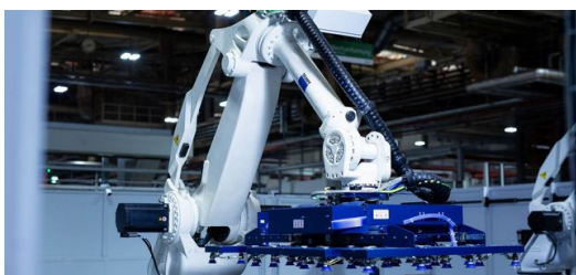
<p>Dva vykládací roboti mají naplno: Vyrobené díly p:icháží v rychlých intervalech z komory pro :ezání.</p>
