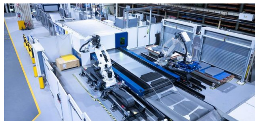
TruLaser 8000 Coil Edition v celkovém pohledu. Na tomto obrázku je dobře vidět, o kolik méně je odpadu při použití svitku místo tabule plechu.
