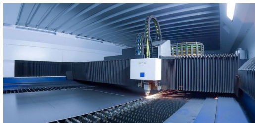
Laserová hlava vyřezává díly z nekonečného pásu plechu pro vnější část traktoru Fendt.
