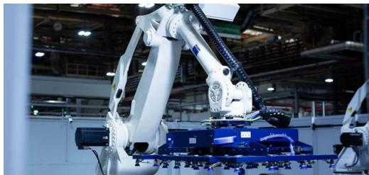
Dva vykládací roboti mají náplň: Vyrobené díly přichází v rychlých intervalech z komory pro upevnění.
