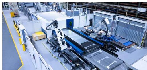
TruLaser 8000 Coil Edition v celkovém pohledu: Na tomto obrázku je poznat, o kolik méně zůstává odpadu z plechu, když Fendt řeže z cívky místo z tabule plechu.
