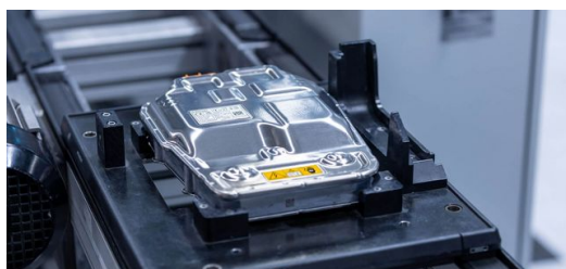
Laser 1: Plynotěsné svařování hliníku. Webasto používá diskový laser, který i pod atmosférickým tlakem pracuje bez ochranného plynu – pokud možno rychle, výkonně a se svařem bez porů.
