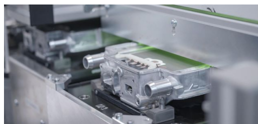
Laser 2: Kontaktování mřídi se zeleným laserem. Zelená vlnová délka laseru TRUMPF má větší stupeň absorpce v mřídi. Se správnou sekvencí pulzu lze hloubky provedení realizovat s extrémní přesností opakování – bez ostříků a zcela bez ochranného plynu.
