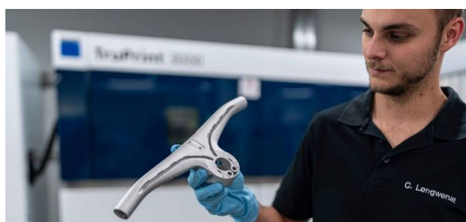
<p>Základem řídítek je v podstatě jednotka s polo-interními kanály pro brzdový kabel.</p>
