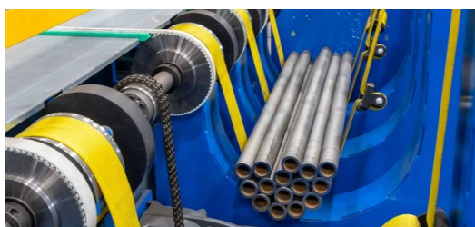
Po přejezu trubky na TruLaser Tube 7000 jsou trubky přepraveny ke spojenému zařízení, kde je robot vloží do závěsu na svazek trubek a následně je na stole jednotli.
