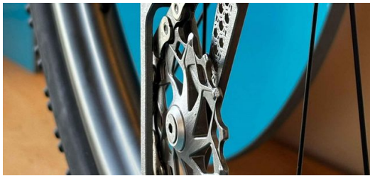
Das Bild zeigt die Verwendung von 3D-gedruckten Bauteilen für die Marke Dangerholm.
