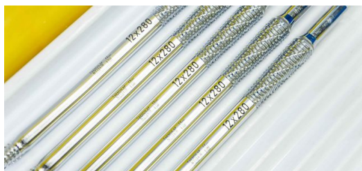
TruMicro Mark - najbrži i najprecizniji laserski marker na svijetu. On omogućuje precizno i pouzdano označavanje najmanjih dijelova u medicinskoj tehnici.
