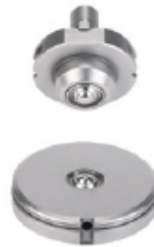
Kugelentgratwerkzeug: Die beiden Kugeln in Stempel und Matrize verprägen den Stanzgrat.
