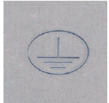
Optimale Prägung – mit der adaptiven Hubkalibrierung.
