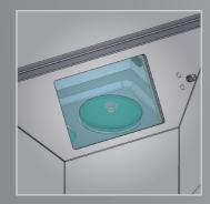
1) Überlaufbehälter wird vor der Entnahme verschlossen
